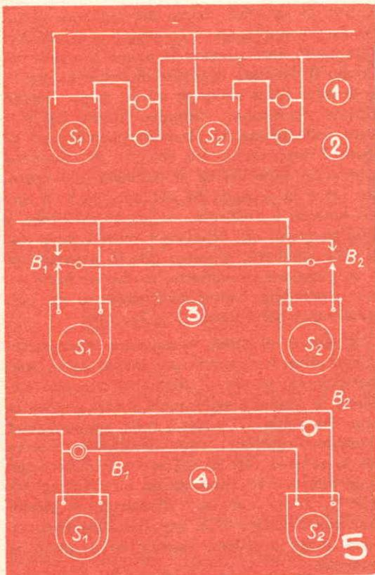
Qui, l'interruttore (8) a due posizioni determina la suoneria da comandare alternativamente, mentre la chiusura dell'interruttore (7) comanda contemporaneamente le due suonerie da (B) qualunque sia la posizione di (8).
