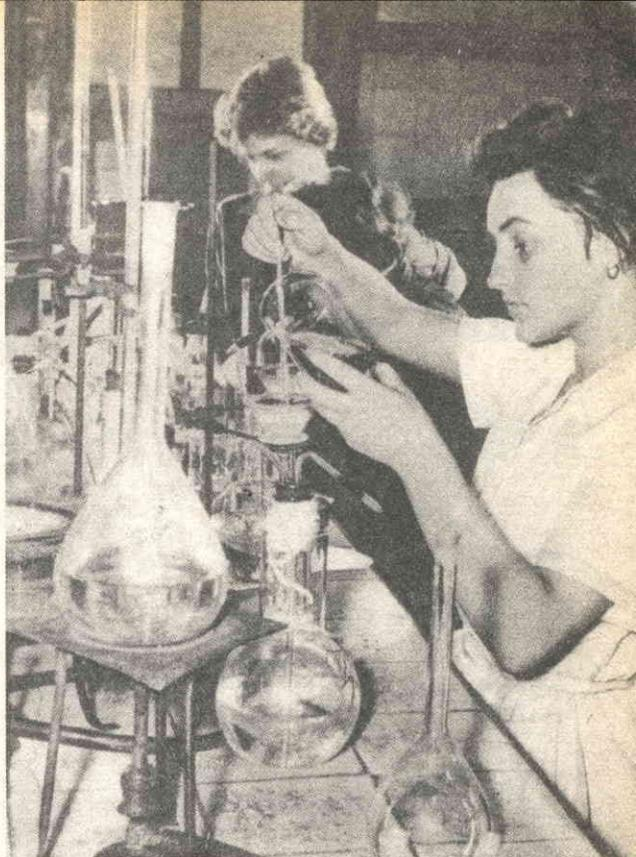
due. A questo punto agiteremo leggermente scuotendo la provetta e guardando fissamente il liquido. Questo perché il colore che appare cambia molto rapidamente e bisogna stare attenti a notarlo prima che scompaia. Aggiunto l'acido solforico e agitato, compare una bella colorazione violetta, molto rapida, che si trasforma molto presto in un colore rosso bruno smorto. Gli altri olii di pesce non danno questa reazione violetta, ma soltanto e subito il colore rosso bruno o semplicemente bruno.
