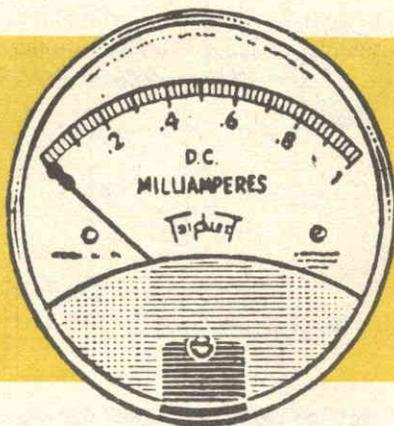
scala direttamente con i valori delle resistenze. Su di un quadrante di tali strumenti si osserverà che detta scala non è lineare ma le divisioni sono irregolari perché ricavate dalla nota legge di Ohm.
