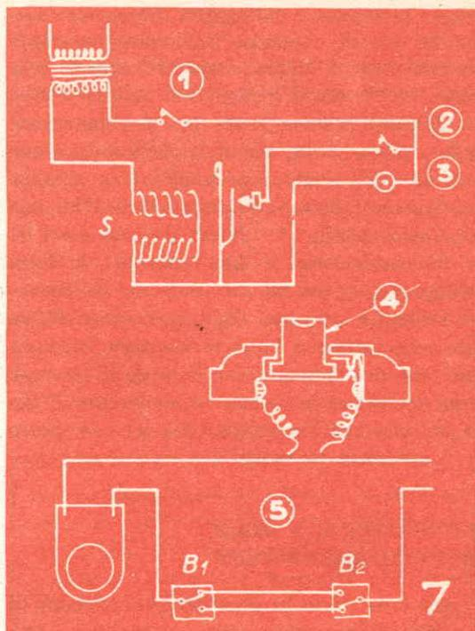
nea. Ne risulta lo schema (1, fig. 7). I bottoni (1 e 2) hanno le loro lamelle in contatto per la posizione riposo (4); essi funzionano dunque al contrario del bottone normale. Il bottone (3) infine è del tipo solito e serve a stabilire la chiamata.
