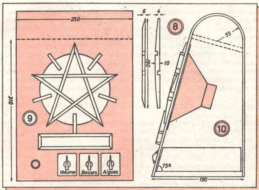
sto eseguito per mezzo di tavole di 1 cm. di spessore e di compensato molto sottile. Ciò non gli impedisce di adempiere a meraviglia al suo compito. Il fondo ed i lati sono stati segati in una tavoladi 1 cm. di spessore. Il foglio di compensato è servito ad affettuare le parti posteriore, anteriore e superiore.
