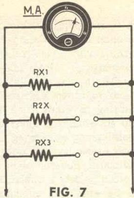
lora la resistenza sia di 50 ohm l'indice si sposterà ad un terzo della scala ed infine se la resistenza è di valore 0, lo strumento non si muoverà dalla sua posizione zero. Tarando quindi lo strumento con resistenze campioni poste in parallelo e di valore dai 50 ai 1000 ohm, si ottiene una seconda portata. In tal modo si possono eseguire letture di resistenze di valore basso.
