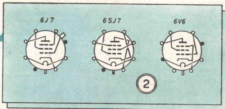
Facciamo osservare che la figura 2 ci indica le connessioni allo zoccolo delle valvole impiegate.
